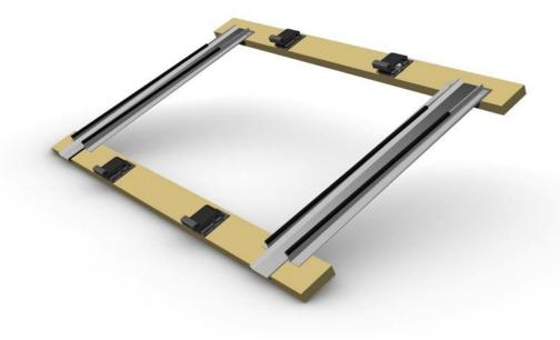
Um das Panel zu verlegen, neigt man es und führt zuerst die obere Kante unter die oberen Haken, schliesst die DC-Stecker an, klappt das Panel um und schiebt es nach unten, sodass die untere Seite in den unteren Haken gehalten wird. Dann wird ein Sperrschlüssel in einen der oberen Haken gelegt, um das PV-Modul zu arretieren (siehe Anhang 6). Der Sperrschlüssel ist so konzipiert, dass er leicht entfernt werden kann, wenn ein Modul zu Wartungszwecken abgenommen werden muss.
