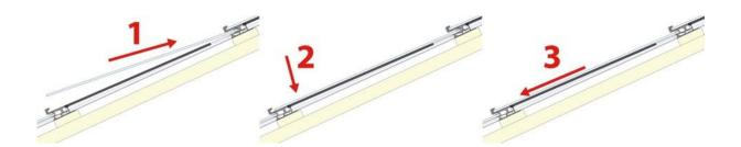
**Empfehlung:** Die Verwendung von 2 Glasergriffen mit Saugnäpfen erleichtert das Anbringen und die abschliessende Justierung der Positionierung der Platte.
